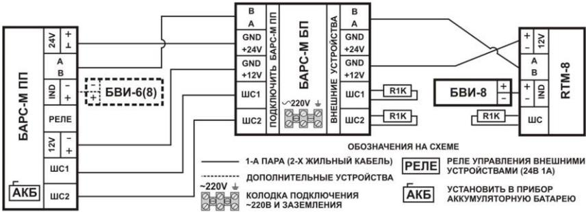
СХЕМА ПОДКЛЮЧЕНИЯ БАРС-М ВАРИАНТ - В
