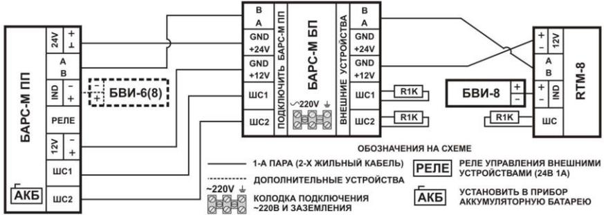
СХЕМА ПОДКЛЮЧЕНИЯ БАРС-М ВАРИАНТ- В
